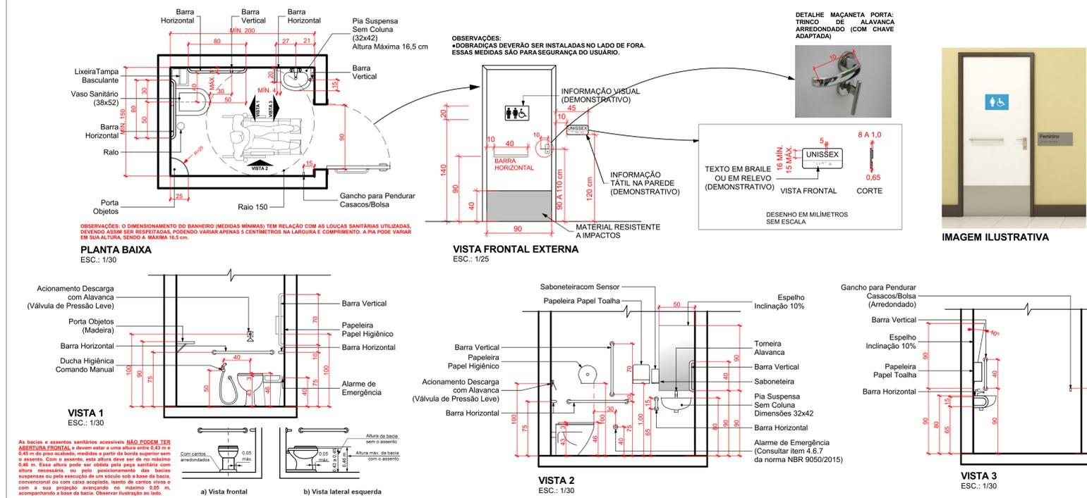
OBS: AS BARRAS DE APOIO DEVERÃO RESPEITAR O DIÂMETRO MÍNIMO ESTABELECIDO PELA NORMA, PODENDO SER DE Ø 3 A Ø 4.5 mm (ITEM 7.6.3 NBR 9050/2015) QUALQUER DÚVIDA QUANTO AS MEDIDAS OU ESPECIFICAÇÕES CONSULTAR NORMA NBR 9050/2015 OU ENTRAR EM CONTATO COM OS AUTORES DO PROJETO.
