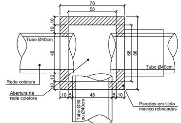
Obs.: Todas as peças especificadas em concreto armado terão malha 15x15 Ø8mm
