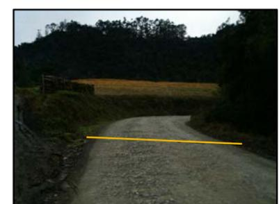
1+098 - Executar BSTC D=0,60m; Comprimento = 12,00m; Executar caixa a montante e boca a jusante; Executar enrocamento com pedra de mão arrumada; Executar proteção vegetal com 12 mudas de árvores locais e dissipador de energia com pedra de mão; Classificação do material com escavação em solo.
